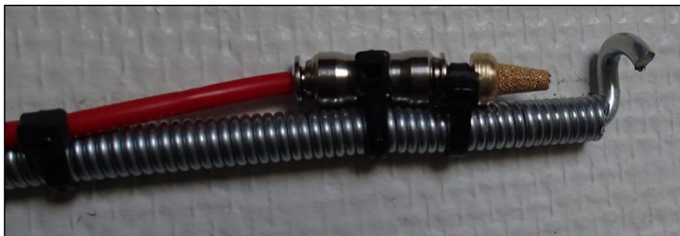
Figur 4-2. Prøvetagningslange med sintret metalfilter monteret på søge-fjeder med krog.
